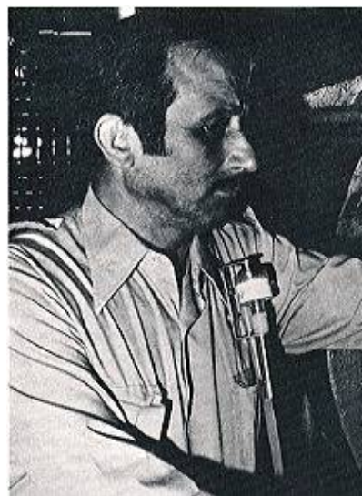
Fig. 6: Toma de muestra con cassette ciclón
