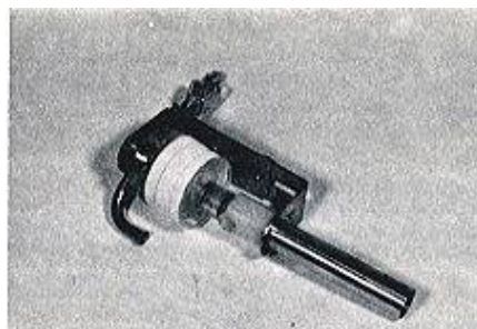
Fig. 3: Unidad de captación cassette-ciclón
